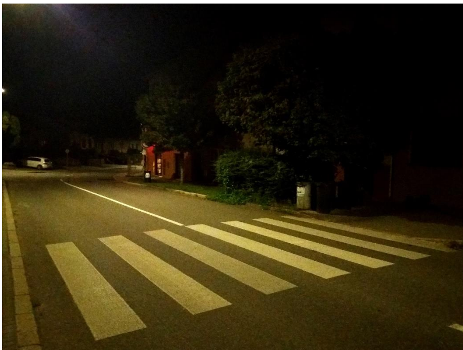
Obrázek 5: Šimáčkova 68 - špatně viditelná dopravní značka „Zákaz odbočení vlevo“, a také přerostlá zeleň přímo u přechodu pro chodce zvyšuje riziko nehody mezi chodcem a vozidlem.
