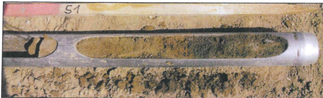
Obr. 2.2: Vrstva humózní hlíny hnědé barvy na povrchu rostlého terénu a žlutohnědá navážka v nadloží v sondě S1
