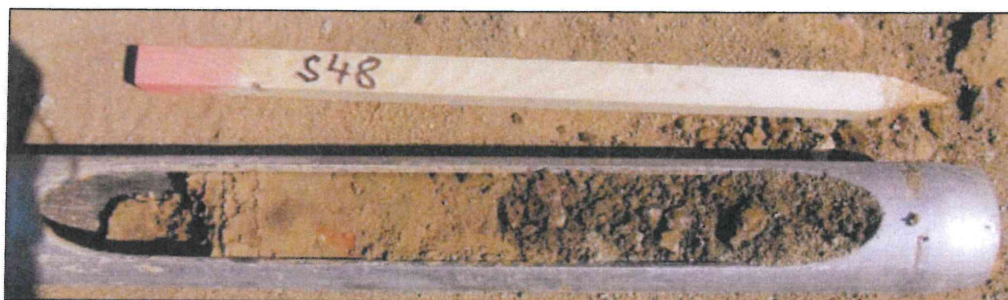
Obr. 2.3: Svrchní vrstva navážky ze sprašové hlíny žlutohnědé barvy a hnědorezavý štěrčopísek v podloží v sondě S48
