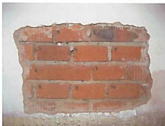
Foto 4 Detail na připravené zkušební místo Z2 s označenými zdíci prvky, na kterých byly provedeny NDT pevnostní zkoušky zdiva
