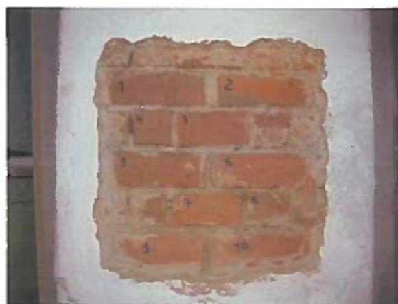
Foto 6 Detail na připravené zkušební místo Z3 s označenými zdicími prvky, na kterých byly provedeny NDT pevnostní zkoušky zdiva
