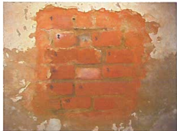
Foto 8 Detail na připravené zkušební místo Z4 s označenými zdícími prvky, na kterých byly provedeny NDT pevnostní zkoušky zdiva
