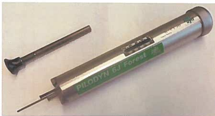
Obr. 7 - Přístroj Pilodyn 6J Forest
