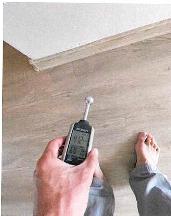
Spodní úroveň - Vlhkost 4%
